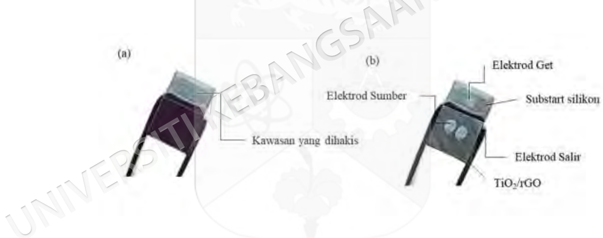
Rajah 4.15 Gambarajah \text{TiO}_2/\text{rGO} -FET yang digunakan untuk pengesanan DNA
