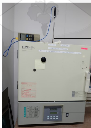
Rajah 3.2 Proses rawatan haba pada suhu 520^{\circ}\text{C} selama 12 jam terhadap sampel AA2024 menggunakan relau.
