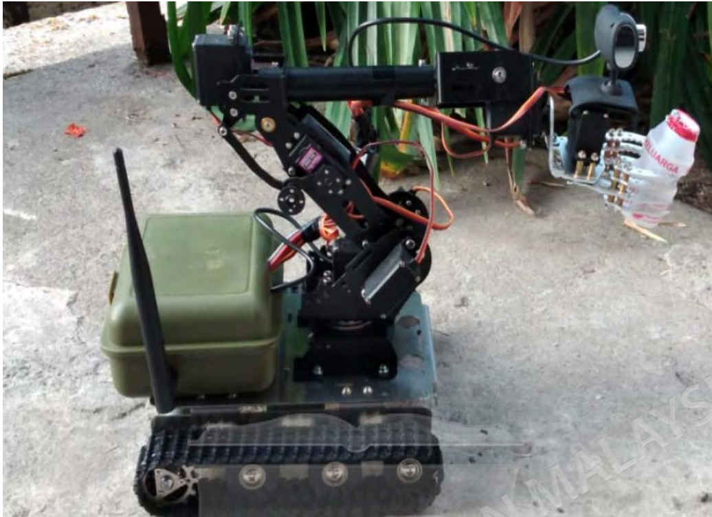
Rajah 4.4 Gambar sebenar reka bentuk sistem robot berautonomi
