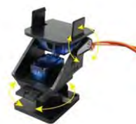
Rajah 3.4 Susun atur reka bentuk sistem pengimbasan menggunakan penerima LiDAR
