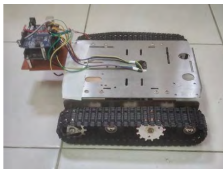
Rajah 4.2 Gambar sebenar reka bentuk sistem navigasi robot
