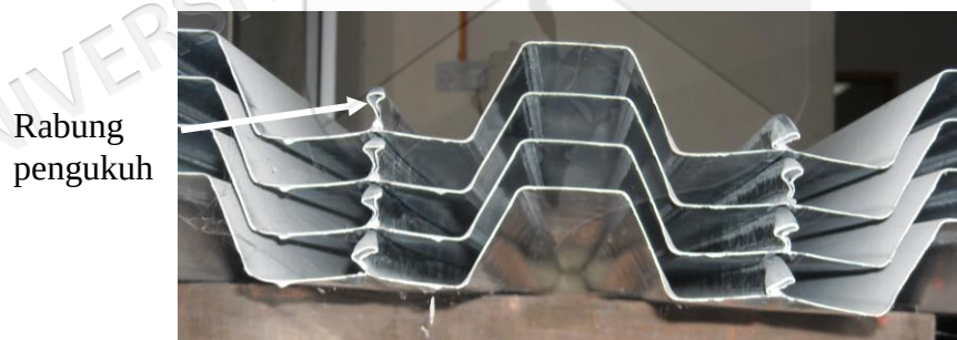
Gambar 3.16 Rabung pengukuh menghalang keluli berprofil dari bertindan rapat bila disusun di atas satu sama lain
