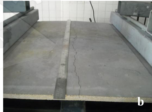
Gambar 3.18 (a) Panel di bawah pembebanan dan (b).papan kering retak di bahagian tengah panel
