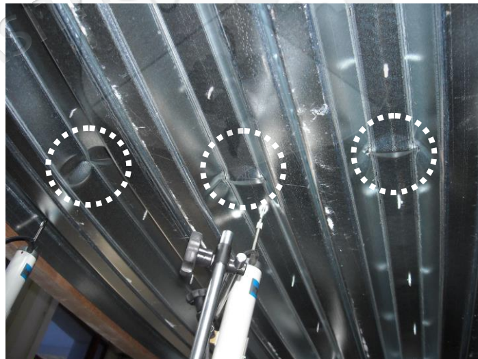
Rajah 3.10 Lengkokan tempatan berlaku dalam satu garisan melintang di mana hujungnya adalah tempat jalur kayu patah
