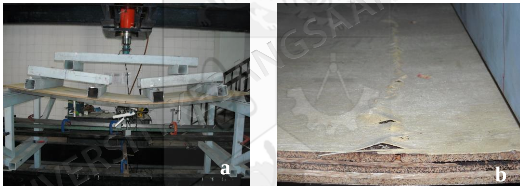
Gambar 3.4 Keadaan panel setelah (a) kegagalan dan (b) kelupasan papan lapis.
