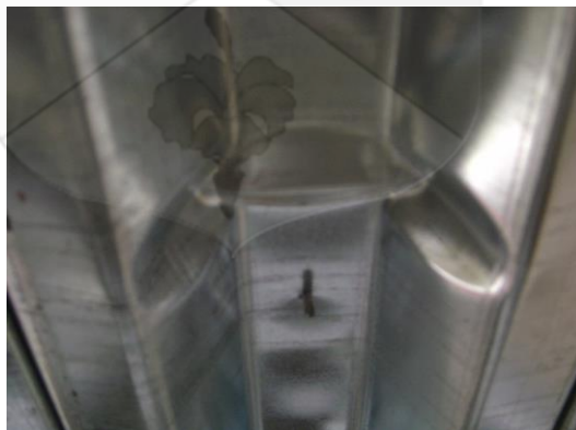
Gambar 3.3 Contoh lengkukan tempatan pada bibir atas yang dirakam dari bawah panel.
