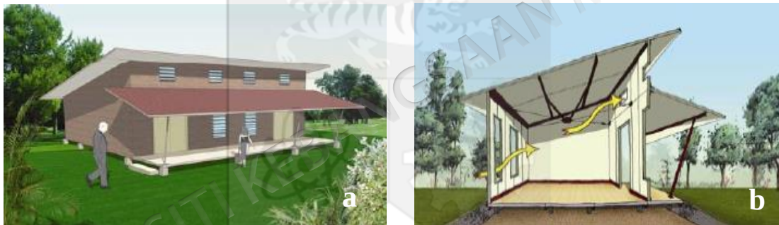
Rajah 6.1 Lakaran kabin menunjukkan (a) pandangan perspektif dan (b) sistem pengudaraan yang baik.
