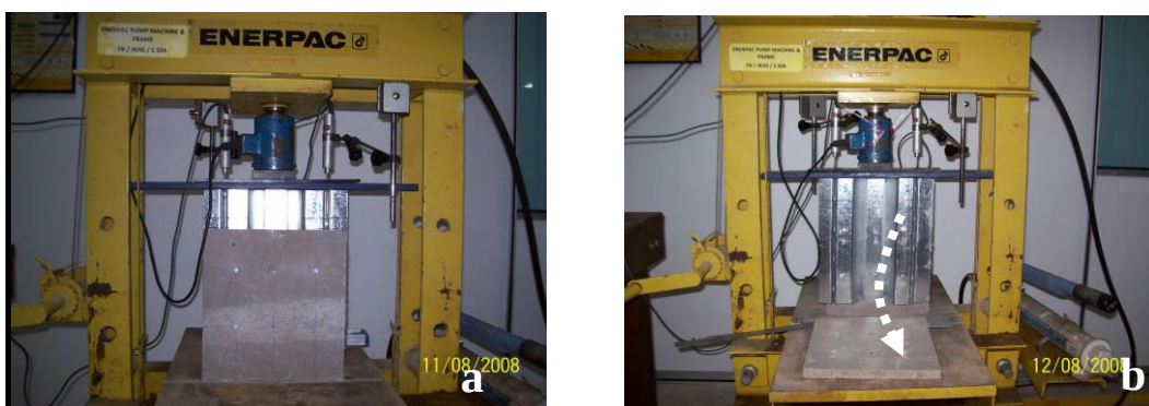
Gambar 4.4 Sampel Peva-Cemboard pada (a) awal ujikaji dan (b) selepas kegagalan.
