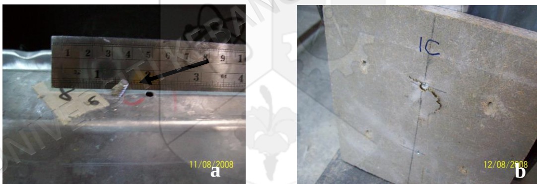
Gambar 4.3 Sampel setelah gagal (a) kepingan keluli dan (b) papan kering
