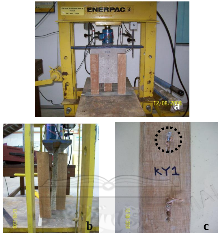
Gambar 4.7 (a) Sampel Cemboard-Kayu pada awal ujikaji, (b) pandangan sisi sesudah kegagalan dan (c) skru yang masih melekat pada kayu.
