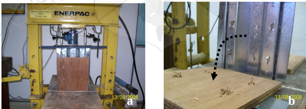
Gambar 4.5 Sampel Peva-Papan lapis pada (a) awal ujikaji dan (b) selepas kegagalan.
