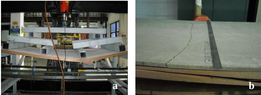
Gambar 3.12 Keadaan panel semasa (a) kegagalan dan (b) keretakan pada papan kering Cemboard
